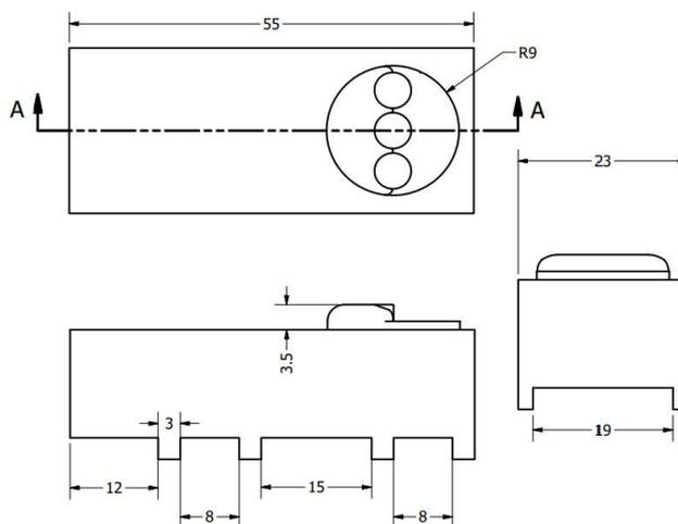
Используя оптическую технологию, датчики семян IR940 работают по принципу фотодетекции. Инфрo-красные светодиоды (LED) создают тонкое световое поле по всей внутренней части семенной трубки. Фотоприемник на противоположной стороне трубки непрерывно контролирует интенсивность света, любые семена, нарушающие источник света, выявляются фотодетектором, и соответствующий импульс передается на монитор. Поставляется с 3 инфракрасными светодиодами для обеспечения точной скорости посева.
